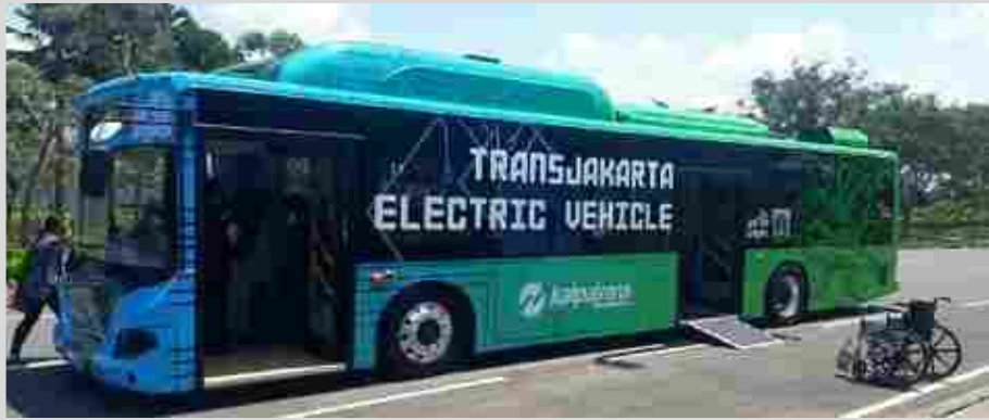
Medium Bus 7 meter Merk : BYD Tipe C6 Dimensi : 7 meter x 2,1 meter x 3 meter
